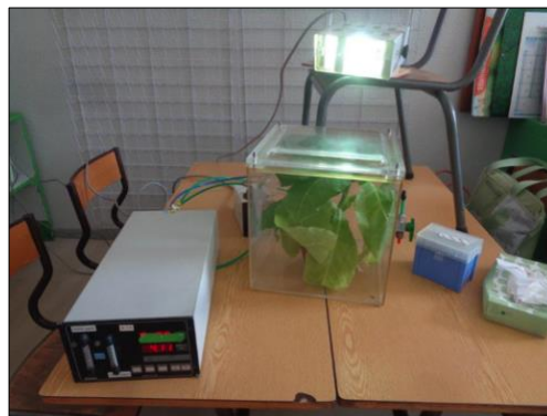
Dispositif permettant de voir la plante faire sa photosynthèse avec un compteur de CO 2
