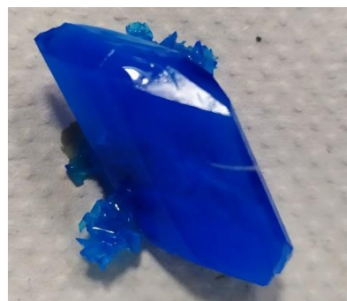
Gros plan sur un cristal de sulfate de cuivre en croissance...avec quelques irrégularités
